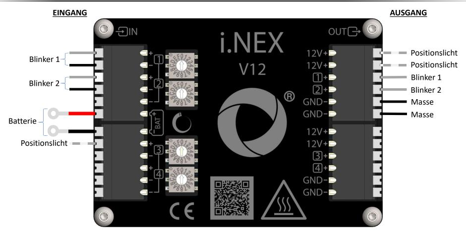
Eingang: Die Farben der fahrzeugseitigen Kabel können abweichen Zum Anschluss an die Batterie immer die mitgelieferten Kabel verwenden!
